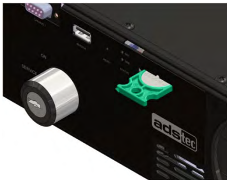
Abbildung 71: Pufferbatterie SRC4310 tauschen - 1
