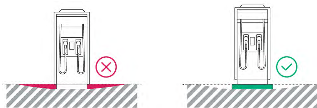
Abbildung 15: Aufstellung ChargePost nicht in Senke
