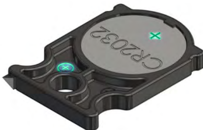
Abbildung 72: Pufferbatterie SRC4310 tauschen - 2
