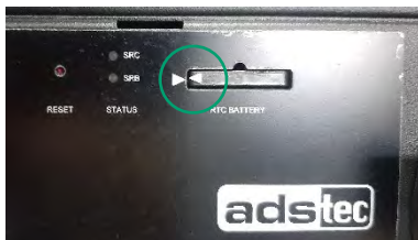
Abbildung 73: Pufferbatterie SRC4310 tauschen - 3
