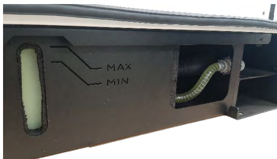
Abbildung 73: Flüssigkeitsstand der Klimaanlage
