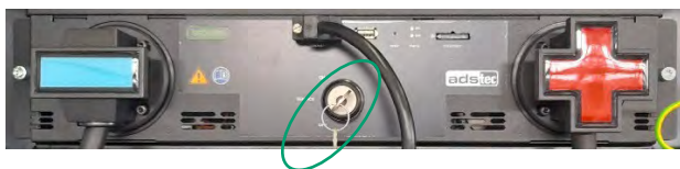
Abbildung 114: SRC4 Schlüsselschalter in Position „OFF“
